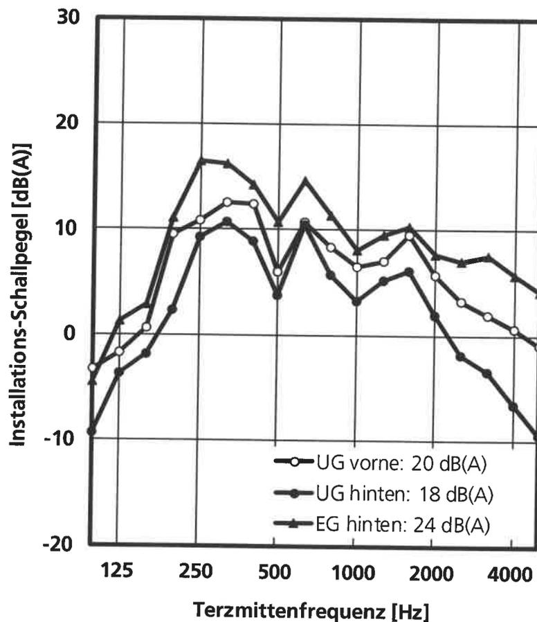
Frequenzverlauf des Installations-Schallpegels bei Geräuschanregung mit dem Körperschall-Geräuschnormal (KGN), gemessen in den Räumen UG vorne, UG hinten und EG hinten. In der Legende sind die Installations-Schallpegel  $L_{A\text{Freq},n}$  in dB(A) nach DIN 4109 für den abgebildeten Frequenzbereich von 100 bis 5000 Hz angegeben.
