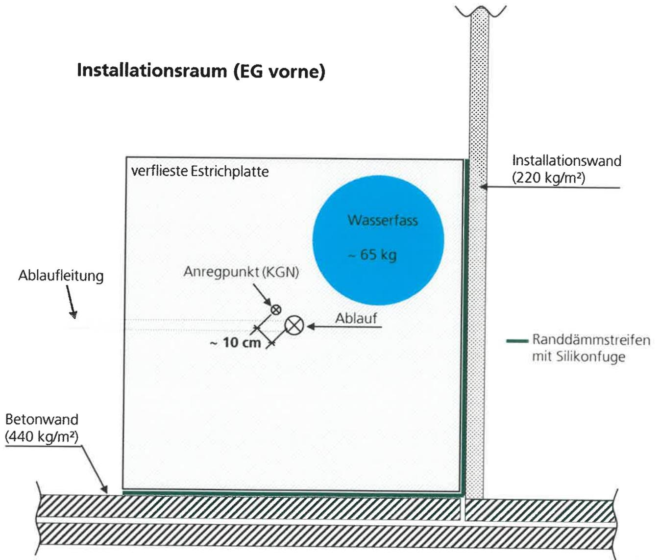
Lage des Prüfaufbaus im Installationsraum (EG vorne).
